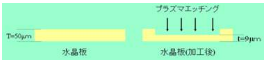
<プラズマによる水晶板の反転メサ加工>
