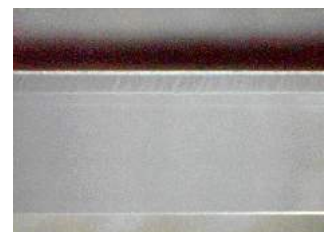
＜完全分断の断面画像＞ 0.7mm アルミノ珪酸塩ガラス
