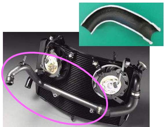
ヤマハ発動機様 大型自動二輪車用冷却パイプ
