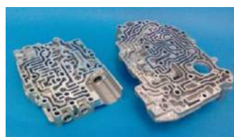
高難易度・重要保安部品を 日本・ベトナムで生産 (CVT バルブボディ)
