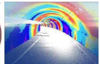
図5. トンネル壁面凸凹解析結果
