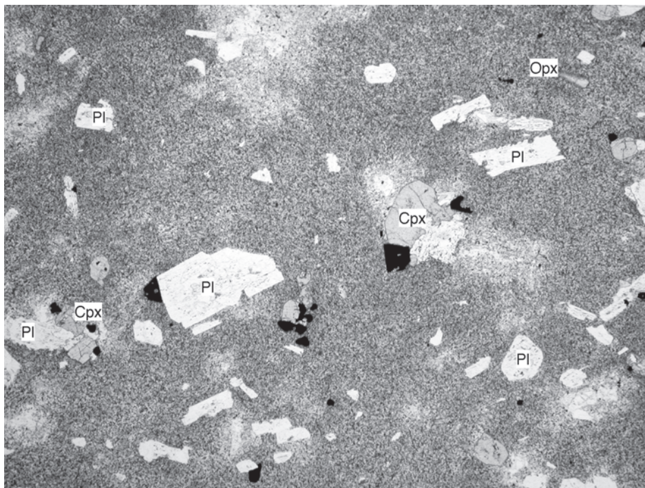
第 9.5 図 磐梯火山最初期火山噴出物(試料 Bn06)の薄片顕微鏡写真 直方輝石単斜輝石安山岩溶岩. 斜長石斑晶 (Pl)・単斜輝石斑晶 (Cpx)・直方輝石斑晶 (Opx) をまばらに含み, 石基はフェルシティック組織を持つ. 写真の横幅は, 6 mm. オープンニコル. 福島県北塩原村町裏磐梯スキー場(北緯 37 度 37 分 52 秒, 東経 140 度 4 分 0 秒). JMA-V19 コア(深度 47.5 m).
