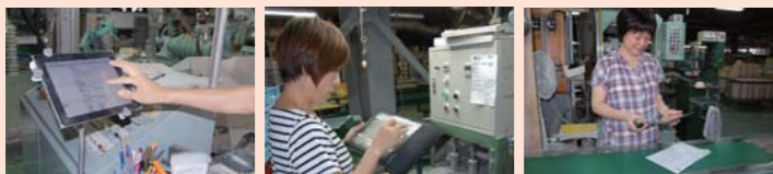
陶器の製造は工場内を移動することが多いので、タブレットが向いている。同時に回っている生産指示書のコードを読み込むと(写真右)、該当する詳細情報の画面をダイレクトに表示させることができる。作業が終了すると終了の登録を行い、指示書と現物を次の工程に回す。
