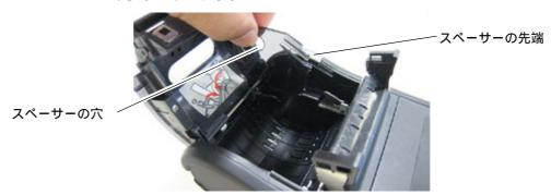
5 使用するロール紙の紙幅に合わせて、スペーサーを移動します。
