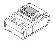
**6** ピーラーカバーを閉じます。 ピーラーカバーを閉じるときは、両端を押してしっかりと閉じてください。
