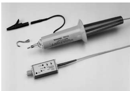
写真6-2 10MHzで4kVピークが測定できる高電圧プローブの一例
