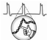
図5-7 最も高速に変化する立ち上り(立ち下り)部分を4個から5個の点で表現できるようなサンプルレートが適切
