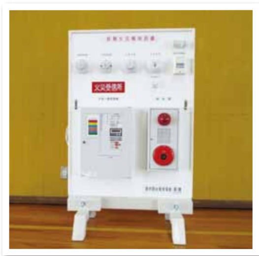
【自動火災報知設備の演習用パネル】
