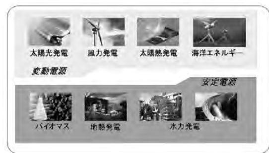
図3 変動電源と安定化電源の分類 (出典：NEDO「再生可能エネルギー技術白書」)
