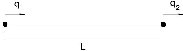
Figura 3.2: Elemento de MVE Unidimensional
