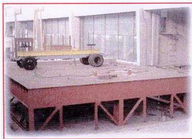
Figura 7.2: Modelo Experimental do Vão Central da Ponte Rio-Niterói (Escala 1:1)
