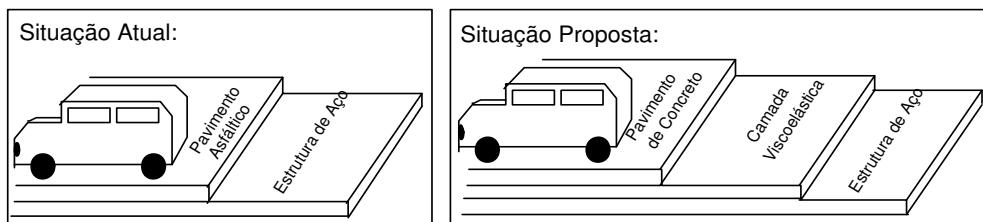
(b) Esquema do Revestimento do Tabuleiro do Vão Central
