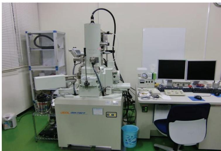
写真 1 電界放出形走査電子顕微鏡 JSM-7001F 型
