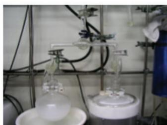
大容量溶媒真空脱気装置
