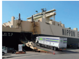
RORO船にトレーラーを積み込む車両の様子
