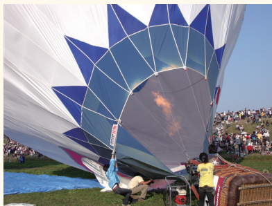
気球を飛ばす準備をしている様子。インフレーターと呼ばれる大きな扇風機で風を入れ、球皮をある程度ふくらませると次はバーナーを焚きながら、熱した空気をさらに入れ込んでいく。立ち上がると気球の高さは20メートルから25メートルになる。ビルの5階とほぼ等しい高さだ。
