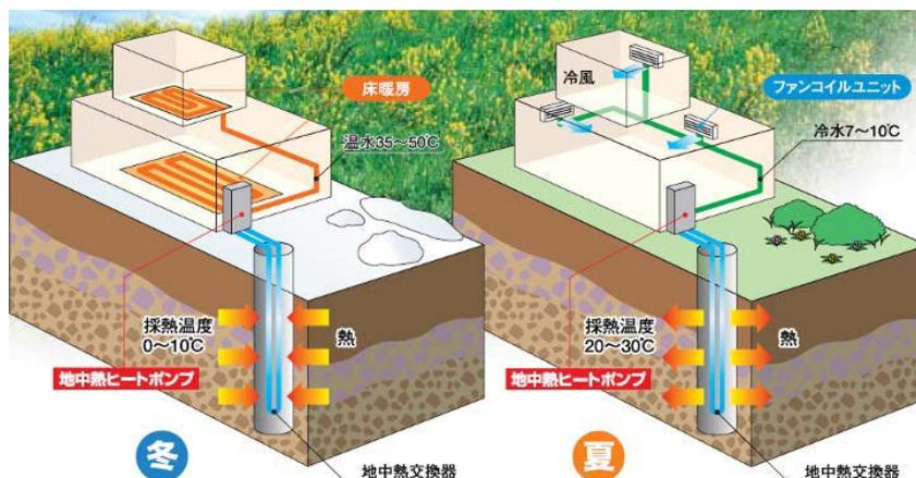
地中熱： 地下の温度は土壌の断熱機能により大気の影響を受けにくく、一年を通してほぼ一定であることを利用し、冬場は、地中から熱をすくい上げる（暖房）、夏場は地上の熱を地中に放出する（冷房）という形で利用するもの。
