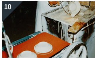
10 施釉(せゆ) 白釉は焼成後、ガラ ス質で透明となり、 陶磁器表面を覆う (釉薬がけ)
