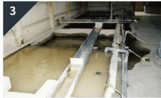
3 水簸(すいひ) 精粉になった陶石を 水に浸し鉄分などの 浮遊物を取る
