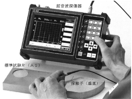
図 5 汎用的な超音波探傷の様子
