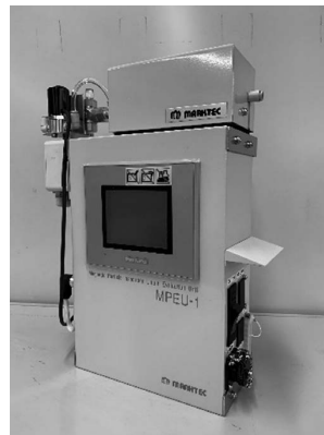
図 2 磁粉液評価装置 MPEU-1（マークテック株）
