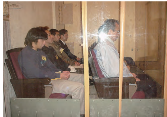
写真-6 椅子吸音力測定状況1 (人着席)
