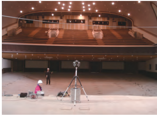
写真-9 残響時間測定状況（大講堂・椅子取付前）
