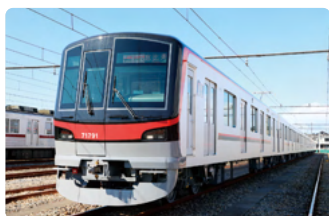
アルミ合金製の軽量車体
