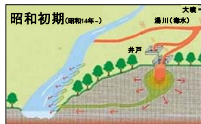
昭和初期の対策工【地下溶透法】
