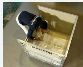
マキシコン内に内袋を設置
