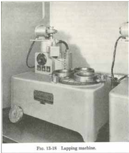
図6 ラッピングマシン Transistor Technology Vol. 1 P318 Fig. 13-18
