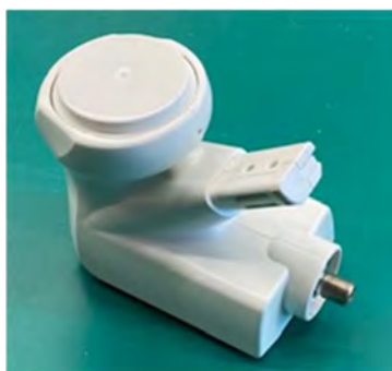
図4. 2-6 ③一次放射器の円形導波管の設計変更による対策モデル 試作品
