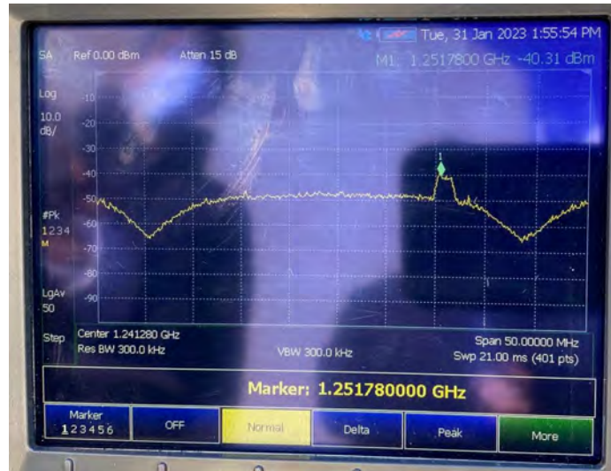
図4. 3-2-1 BS受信画像破綻時のブラックアウト画像とスペアナの観測波形例
