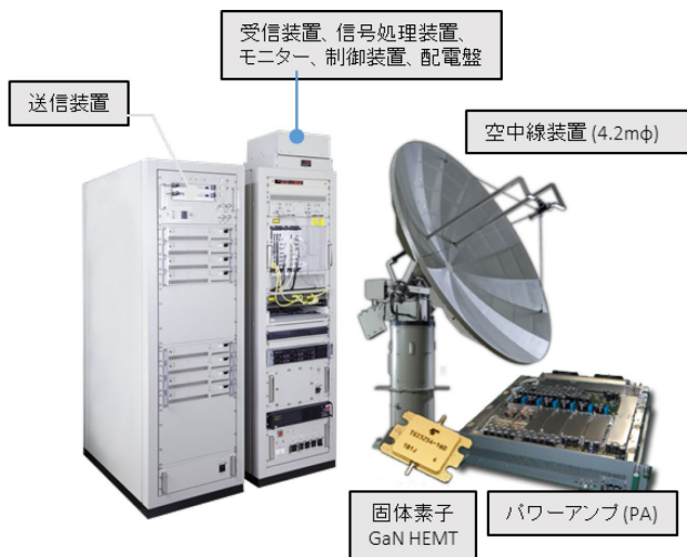
図 2. 3-6 固体化 MP レーダーシステムの外観
