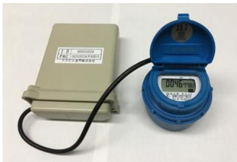
【Sigfox無線発信機(右側は一般的な電子式水道メーターの計測部)】
