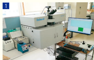
1 生体試料解析用に設計した独自の顕微ラマン装置
