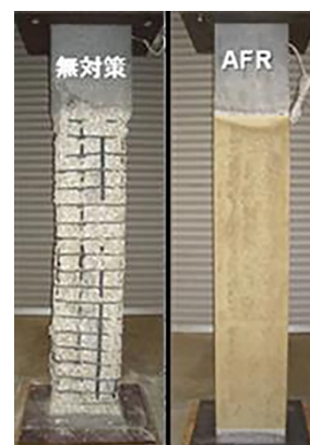
写真-7 AFRコンクリート
