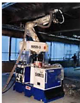
写真-10 耐火被覆吹付ロボット 図-4 ビル自動施工システム
