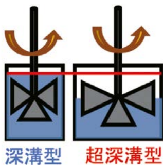
Fig. 6 深溝型と超深溝型での混練イメージの違い
