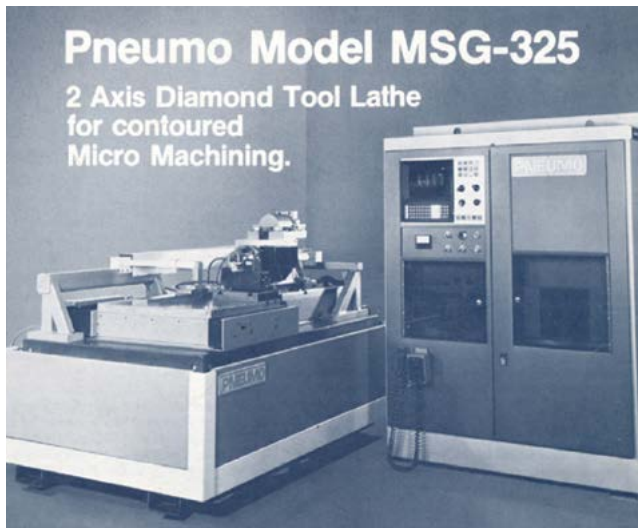
【装置構成および精度】 (1)空気静圧スピンドル:振れ精度=0.1μm (2)空気静圧案内 (3)制御分解能:25 nm
