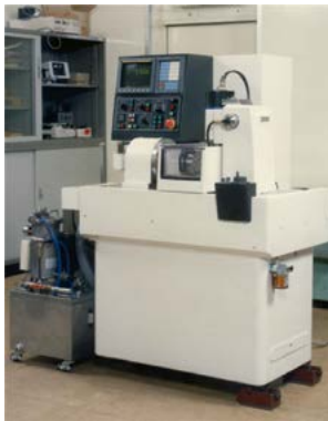
(a)装置の外観 (b)装置の構造 Fig. 27 超精密非球面研削盤ULG-100A(H)の初号機
