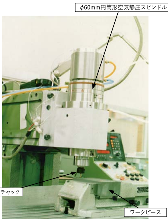
Fig. 20 空気静圧スピンドルを用いたエンドミル加工テスト
