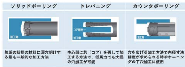
Fig. 2 BTA加工の種類 3)
