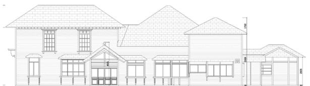
[図 6] 旧今邸, 3D モデルをトレースして作成した CAD の立面図
