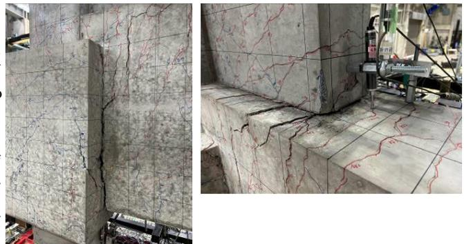
写真-2 最終破壊形状 (左: 基礎梁 右: 袖壁)
