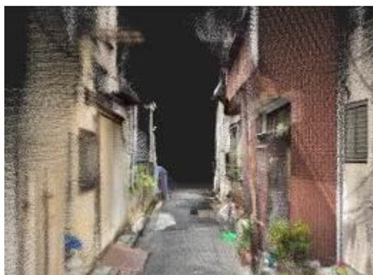
[図 9] iPhone の LiDAR で撮影した月島三丁目の路地の点群データ
