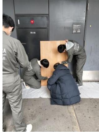
**廃材を用いたテーブル天板の制作:**月島長屋学校で棚板として使われていた廃材を用いて、テーブルの天板を制作した。ダボで接合することで、廃材を有効に活用できることを学んだ。またダボの強度など、実際に製作することで体験的に学ぶことができた。木材の表面をニスで塗装することで、見栄えが良くなること、また汚れを防ぐことになることも体験的に学んだ。
