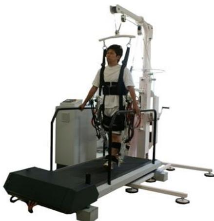
図2 基盤研究 B で開発を進めてきた免荷式歩行訓練システム
