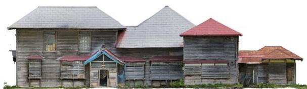
[図 5] 旧今邸, 3D モデルから作成した立面図
