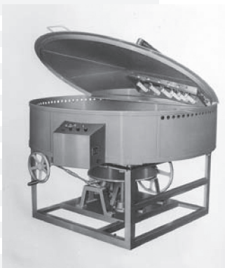
ホエラー（1950年代の平型回転式感光液塗布機）
