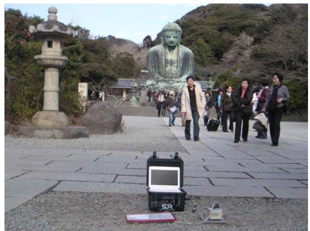
写真1 地盤での常時微動測定状況
