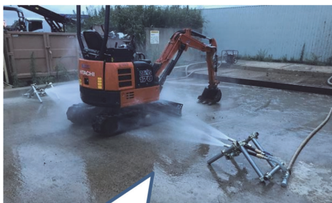
ミニパワーショベル洗車は自動洗車機とほぼ同等の効果が得られる。
