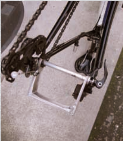
別売リヤエンド金具（他社製）のご利用をお勧めいたします。
