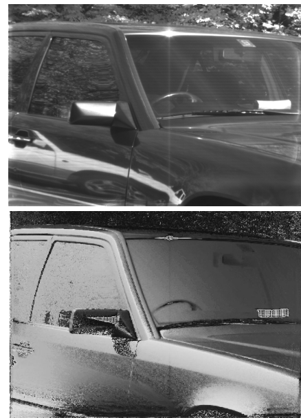
図3. 偏光イメージングカメラで撮影した自動車の画像(上)とその情報から偏光方向を導出し、方向を色で表現した画像(下)。フロントとサイド面の法線方向の違いが色の違いとして表示されている。
