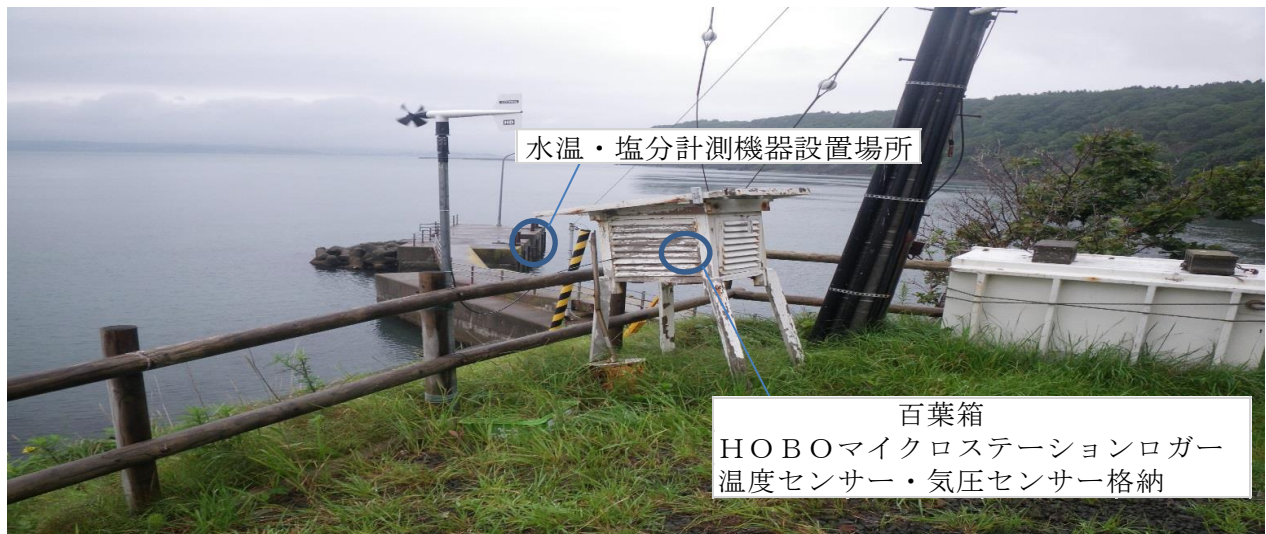
気象観測機器設置場所
