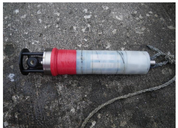
図4 塩分・水温計測機器
