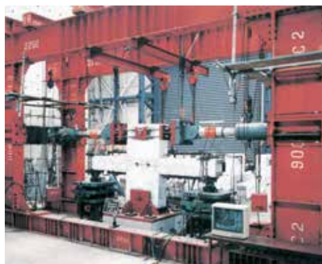
WR-PC工法の架構実験
