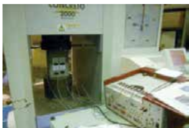
高強度PCのタイル剥離抵抗試験
