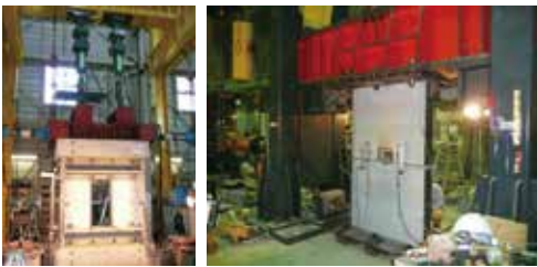
W-PC造新設開口補強実験
