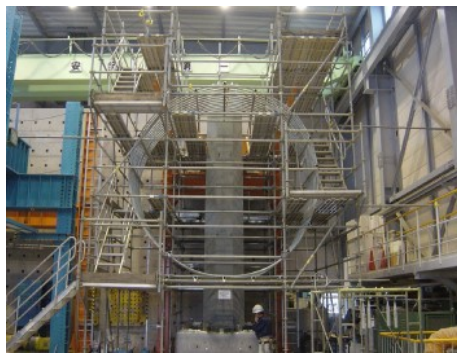
写真-4 グラウト注入試験状況
