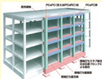
ピーエス三菱PCaPC外付けフレーム耐震補強工法
