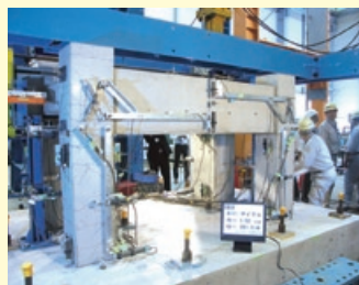
外付けフレーム耐震補強の構造実験
