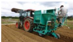
ピレットプランタによるサトウキビ植え付け試験の状況
