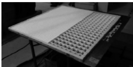
図 2.4.6: 製作中の WAGASCI モジュール。薄いプラスチックシンチレータを格子状に組んだ層と、平面的に並べた層を交互に並べた構造。シンチレータの間の空間に水を入れてニュートリノ反応の標的とする。
