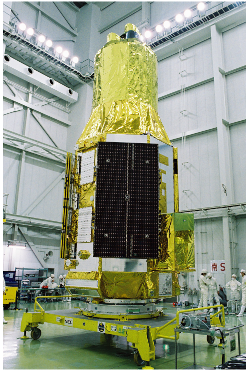
図 1: 宇宙 X 線観測衛星「ひとみ」の打ち上げ前の試験時の写真 (JAXA 提供)。「ひとみ」は日本の 6 代目の宇宙 X 線観測衛星で、重さ 2.7 t、打ち上げ時の高さ 8 m、軌道上での高さ 14 m と、日本で最大級の科学衛星である。最新の X 線検出器を複数搭載し、広い帯域を高感度で観測する力、X 線を精密に分光する力が、過去の衛星より桁違いに優れている。JAXA を中心に東京大学はじめ国内の研究機関に加え、NASA、ESA などの世界の研究機関が協力して開発を進めてきた。(中澤研究室)
