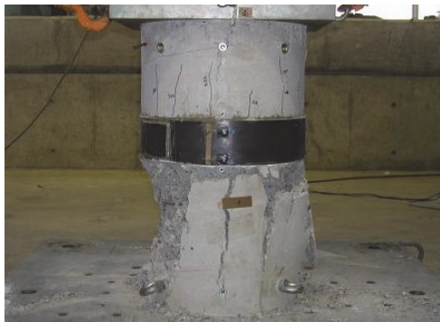
写真-3 試験後の破壊状況 (No.1)
