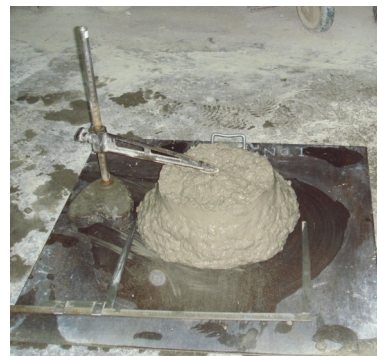
写真-2 再生骨材コンクリートのスランブ試験状況
