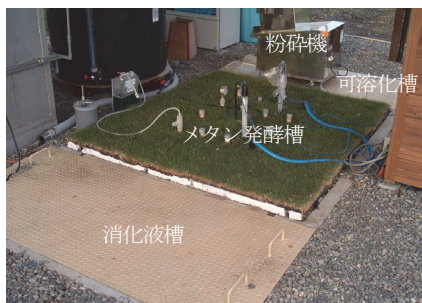
写真-3 小規模メタン発酵実験設備
