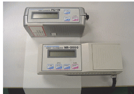
写真-3 明度・光沢度計測(色差計・光沢計)
