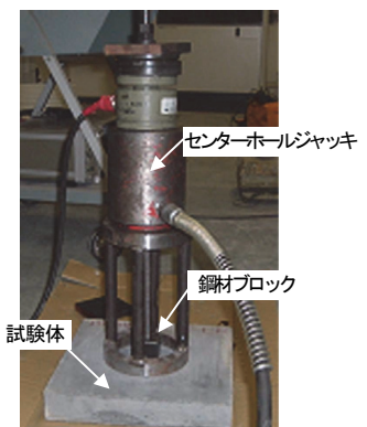
写真-1 接合部の引張実験
