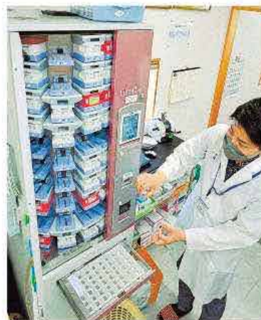
全自動で錠剤を分類、 分別して包装する「分 包機」を確認する
