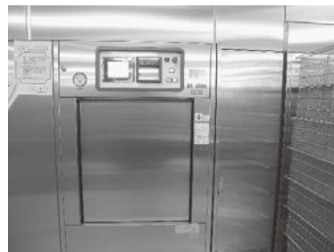
名称 カートリッジ式酸化エチレンガス滅菌装置 設置場所 中央材料室 取得年月日 2022.03.28
