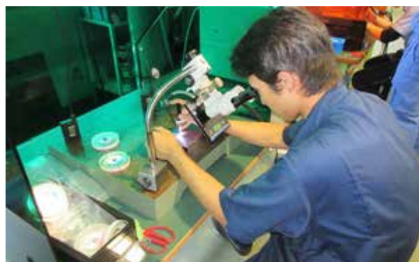
写真5 精密TIG溶接機を使用した肉盛りの様子
