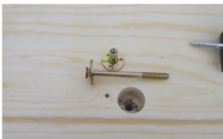
間隔的に内蔵型ボルトで“二次接着”
