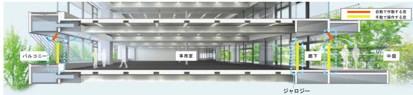
最も気候のいいときを感知して自動開閉する欄間窓、パスダクト、手動開閉窓を通してオフィスから中庭へ換気が行われる
