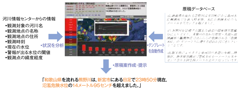
5図 原稿作成支援システムの概要
