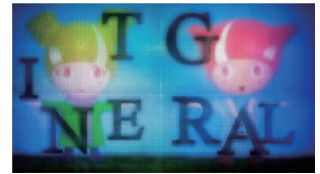
直視型の表示装置により再生したインテグラル立体映像
