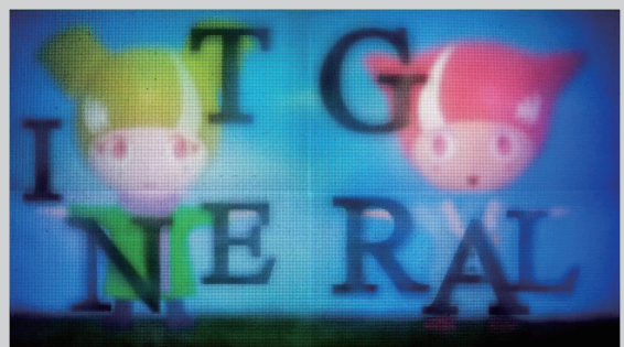
図1 4台の8K液晶パネルを用いた直視型の表示装置により再生したインテグラル立体映像
