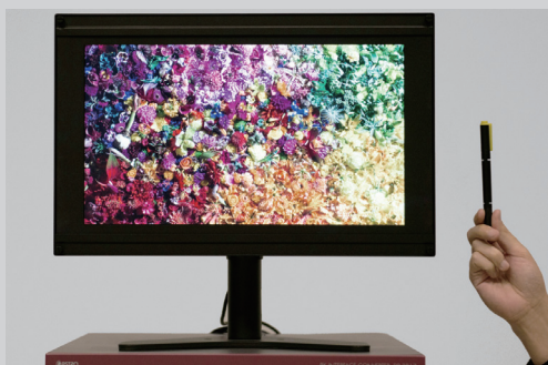
図2 対角17.3インチ8K液晶モニター
