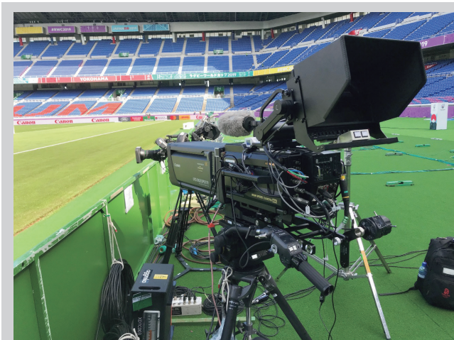
図2-3 競技場に設置された8K 4倍速(240Hz)スローモーションシステム用ハイスピードカメラ
