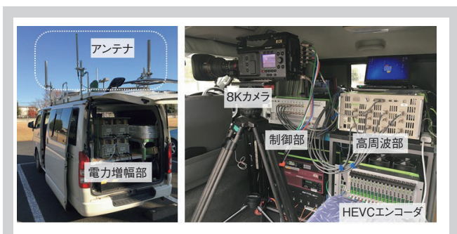
図2-22 試作装置を搭載した実験車両
