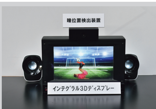
図1-3 視点追従型インテグラル3Dディスプレイによる実写動画表示の様子
