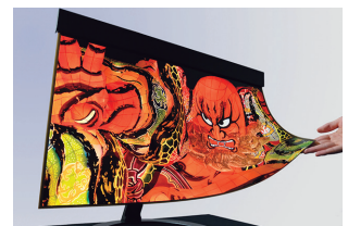
プラスチックフィルムで形成した4Kフレキシブル有機EL ディスプレイ
