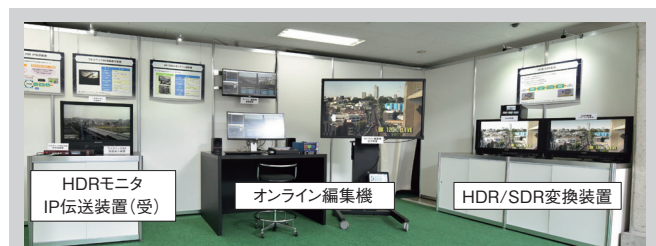
図2-2 8K 120Hzライブ制作実験(受信側)
