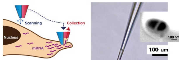
図5 SICMをベースとした局所細胞回収とプローブ先端の電子顕微鏡写真
