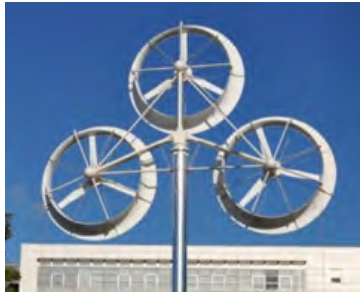
図9 3基の3kW レンズ風車を用いた10kW マルチロータシステム, 九州大学筑紫キャンパス, H27.12.8
