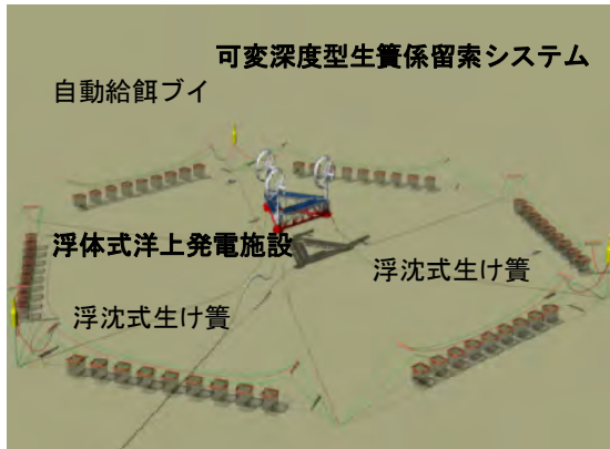
図16 漁業協調の浮体エネルギーファーム．浮沈式生け簀と自動給餌器がエネルギーファームの周囲に配置される．
