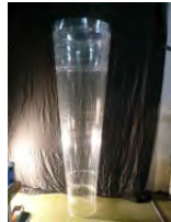
図 20b ディフューザ型タワー
