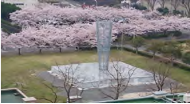
図 28 プロトタイプウインドソーラータワー (WST) を用いた野外実験，タワー高さ 11m，集熱部 15m 四方。
