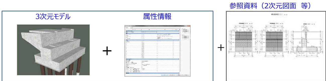
図 2-9 構造物モデルの例
