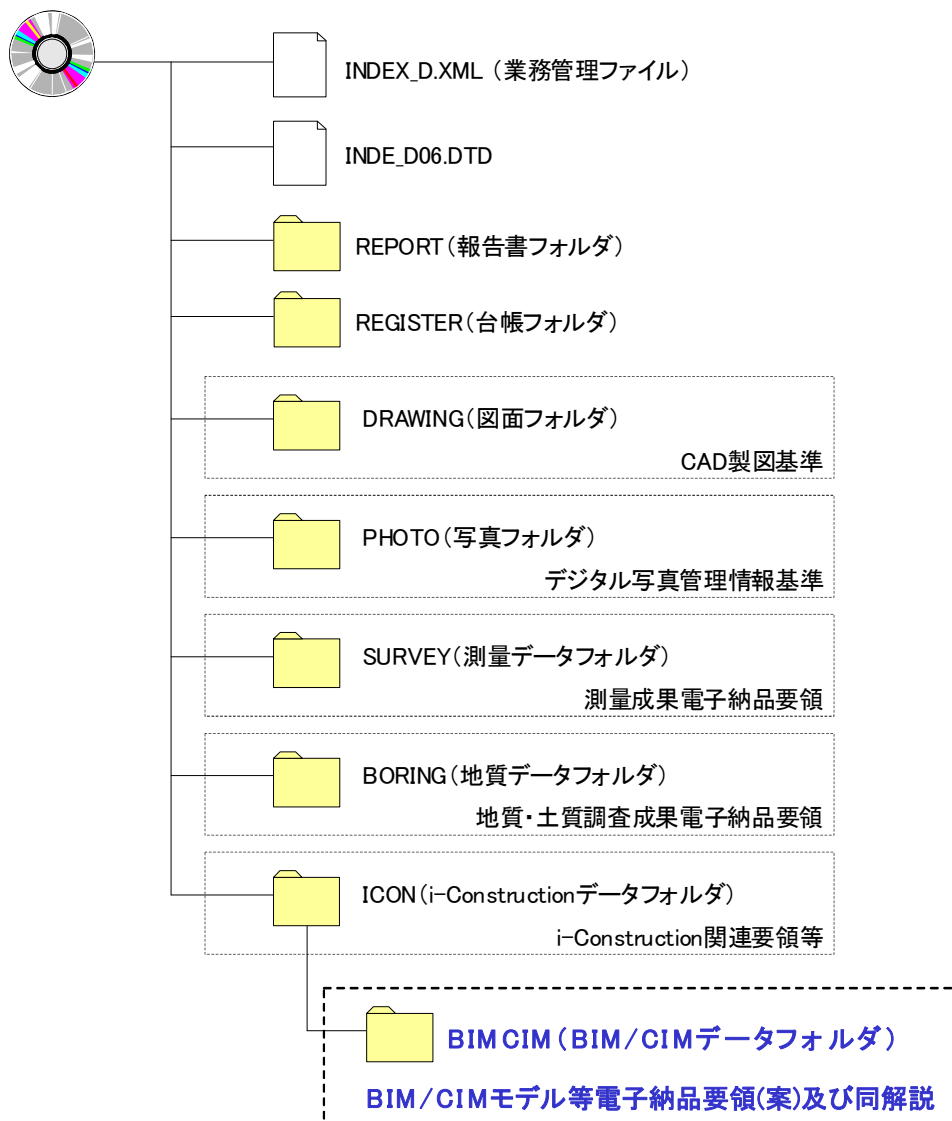
図 1-2 土木設計業務等の電子成果品のフォルダ構成での BIM/CIM データフォルダの位置関係
