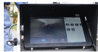
地上部でのモニターにより異常箇所を正確に把握
