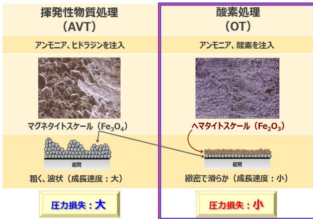
発電用ボイラの水処理
