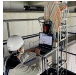
高所作業車を用いた桁下面の測定例
